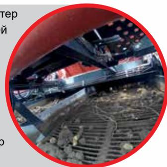
Пальчиковая горка (4) шириной 2,7 метра, содержащая два пальчиковых полотна, осуществляет первую интенсивную чистку. Оптимальная регулировка угла и скорости обеспечивает превосходную чистку. Почва и ботва удаляются изготовленным из ПВХ транспортером для удаления отходов (5) непосредственно перед задним колесом машины. Под пальчиковой горкой можно установить опциональный картофелеудерживающий валик, чтобы гарантировать бережное перемещение картофеля на чистящий модуль.
