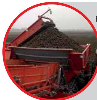
Вместимость бункера (10) с автоматическим заполнением – 17,5 м<sup>3</sup>. Это – важное преимущество при обработке длинных участков с высокой урожайностью. Состоящий из одной части бункер позволяет быстро осуществлять выгрузку всего содержимого или выгружать урожай на ходу. Бункер оснащен автоматическим гидравлическим натяжителем, благодаря которому цепь бункера всегда натянута правильным образом и меньше изнашивается.
