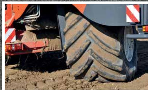
Оptionальное сверхширокое заднее колесо (1250/50 R32) с давлением воздуха в шине 1,4 бара.
